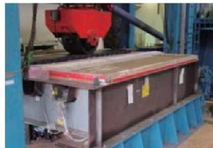
(独)土木研究所・水浸(鋼床版) 輪荷重走行試験
