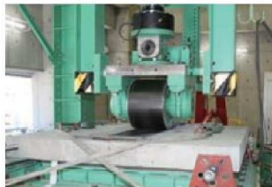
日本大学生産工学部(RC床版) 輪荷重走行試験
