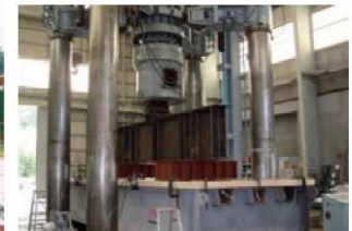
首都高速道路(株)・水浸(鋼床版) 定点疲労試験(施工技術総合研究所所有)
